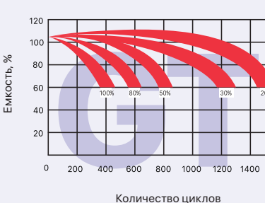
Влияние глубины разряда на циклический ресурс
